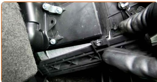
**10** Vissez les attaches du couvercle du boîtier du filtre d'habitacle. Utilisez une douille n° 5.5. Utilisez une clé à cliquet.
