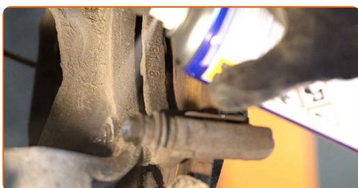
**12** Dévissez l'attache du support d'étrier. Utilisez une douille n° E12. Utilisez un porte-taraud.
