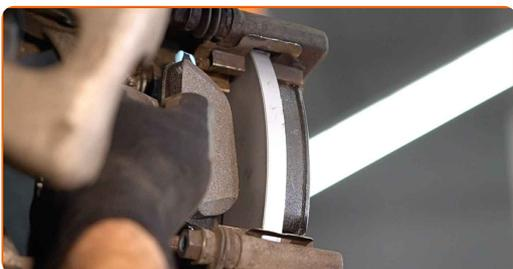
**28** Installez l'étrier de frein et fixez-le. Utilisez une clé mixte de No.13 Utilisez une clé mixte de No.15 Utilisez une clé dynamométrique. Serrez-le jusqu'à 35 Nm.
