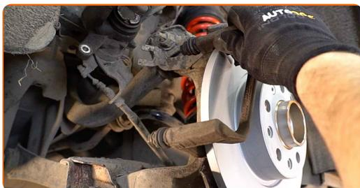
**23** Serrez le support de l'étrier de frein. Utilisez une douille n° E12. Utilisez une clé dynamométrique. Serrez-le jusqu'à 60 Nm.
