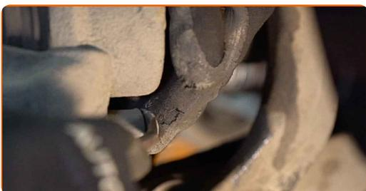
8 Déconnectez le connecteur du capteur d'usure de plaquette de frein.
