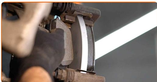
**33** Installez l'étrier de frein et fixez-le. Utilisez une clé mixte de No.13. Utilisez une clé mixte de No.15. Utilisez une douille n° 13. Utilisez une clé dynamométrique. Serrez-le jusqu'à 35 Nm.
