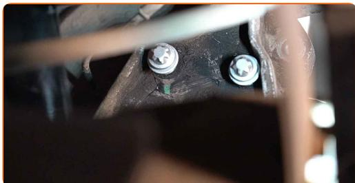
**25** Serrez le moyeu. Utilisez une douille n° E14. Utilisez une clé dynamométrique. Serrez-le jusqu'à 77 Nm.
