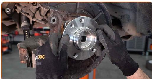
**24** Installez les boulons de fixation.
