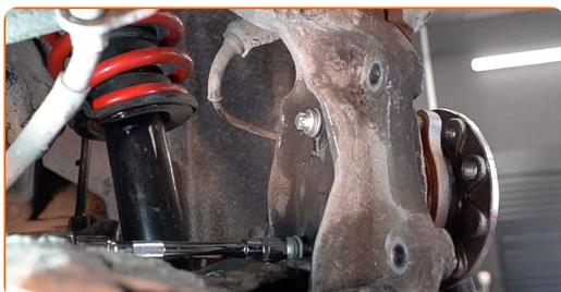
**26** Lubrifiez le moyeu à l'endroit où il est en contact avec le disque de frein. Utilisez de la graisse au cuivre.
