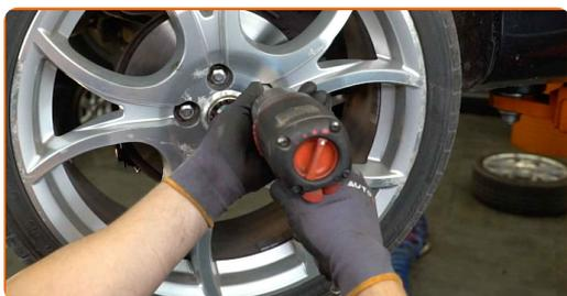
**34** Abaissez la voiture et serrez les boulons de roue en ordre croisé. Servez-vous d'une douille à choc pour roue N°17. Utilisez une clé dynamométrique. Serrez-le jusqu'à 108 Nm.
