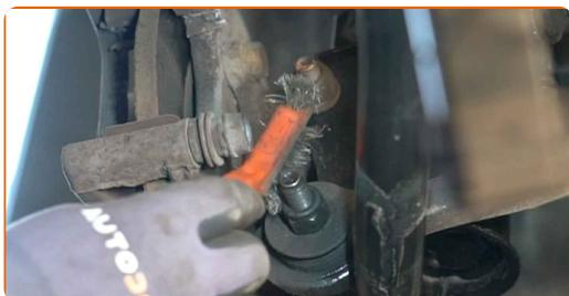
**14** Dévissez l'attache du support d'étrier. Utilisez une douille n° 17. Utilisez une clé à cliquet. Utilisez un porte-taraud.
