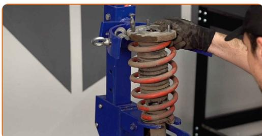
Remplacement : jambe de suspension – ALFA ROMEO Brera (939\_). Les experts d'AUTODOC recommandent :
