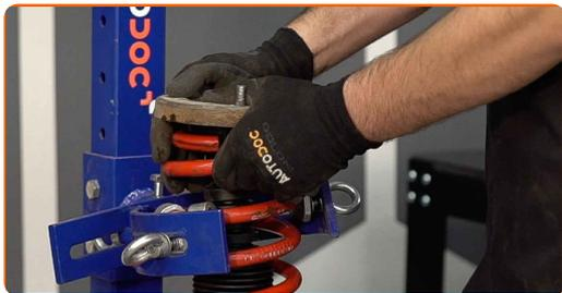
**34** Serrez l'écrou de l'entretoise d'amortisseur due la tige de piston. Utilisez une clé mixte de No.6 Utilisez une clé mixte de No.18. Utilisez une douille n° 18. Utilisez une clé dynamométrique. Serrez-le jusqu'à 33 Nm.
