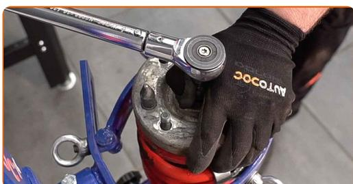
Remplacement : jambe de suspension – ALFA ROMEO Brera (939\_). Les professionnels recommandent :
