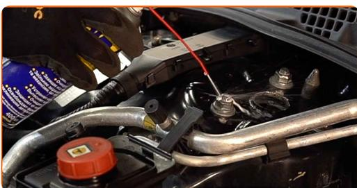
**4** Devissez la fixation supérieure du support d'amortisseur. Utilisez une douille n° 16. Utilisez une clé à cliquet.
