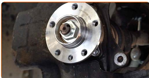
**44** Lubrifiez le moyeu à l'endroit où il est en contact avec le disque de frein. Utilisez de la graisse au cuivre.
