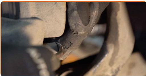
**9** Déconnectez le connecteur du capteur d'usure de plaquette de frein.
