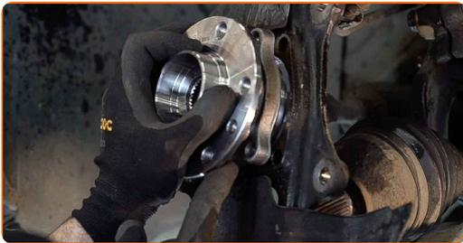
**32** Serrez le moyeu. Utilisez une douille n° E14. Utilisez une clé dynamométrique. Serrez-le jusqu'à 112 Nm.
