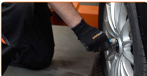
**3** Retirez le capuchon de protection du moyeu de roue. Utilisez un tournevis plat.
