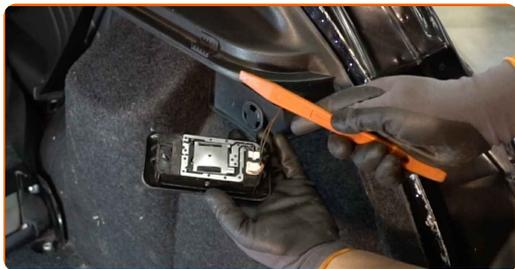
**11** Détachez le connecteur d'ampoule.
