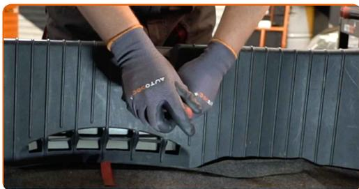
**6** Desserrez les crochets fixant la garniture du coffre. Utilisez la clé HEX n° H5. Utilisez une clé à cliquet.
