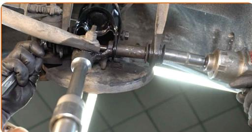
**59** Vissez la fixation qui relie l'amortisseur à la fusée arrière. Utilisez une clé mixte de No.19 Utilisez une douille n° 19. Utilisez une clé à cliquet.
