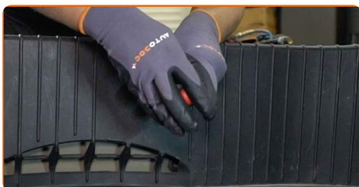
**89** Serrez les crochets fixant la garniture du coffre. Utilisez la clé HEX n° H5. Utilisez une clé à cliquet.
