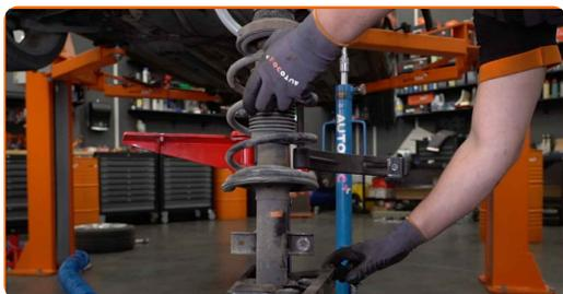
Remplacement : jambe de suspension – ALFA ROMEO GT (937). Les professionnels recommandent :
