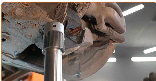
**68** Vissez la fixation arrière reliant la fusée arrière au bras de suspension. Utilisez une clé mixte de No.22
