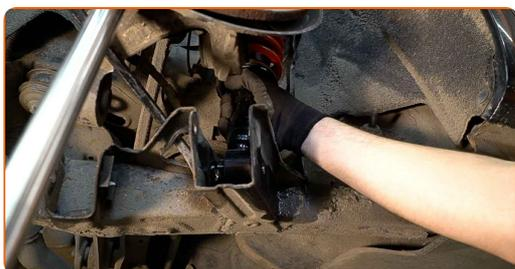
**61** Vissez l'attache supérieure du support de l'amortisseur. Ne serrez pas trop.
