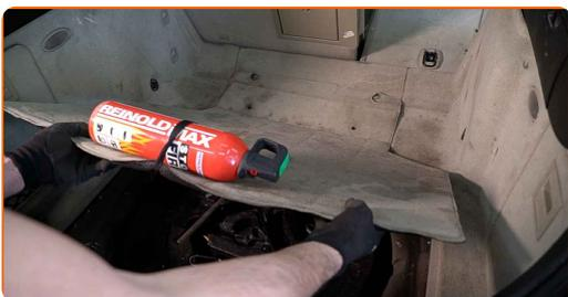
**7** Retirez les attaches de la garniture avant inférieure du coffre. Utilisez un outil d'extraction de clips.
