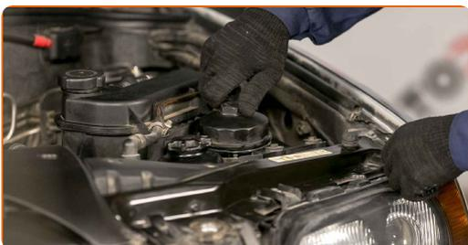
**14.2** Utilisez une douille n° 36. Utilisez une clé dynamométrique. Serrez-le jusqu'à 25 Nm.
