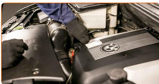
**4** Dévissez le bouchon du compartiment du filtre, ainsi que l'ancien élément filtrant. Utilisez une douille n° 36. Utilisez une clé à cliquet.
