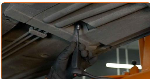
**7** Retirez les clips du panneau de protection du dessous de caisse. Utilisez un outil d'extraction de clips.
