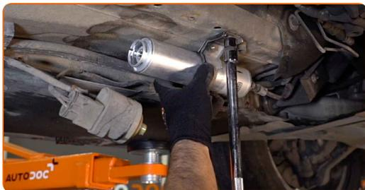
**21** Attachez le régulateur de pression d'essence au filtre à huile. Installez l'anneau d'arrêt du clip de retenue au régulateur de pression d'essence.
