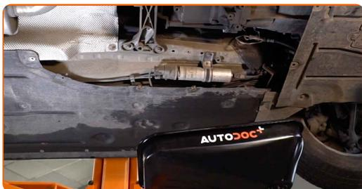
**7** Lubrifiez les fixations qui relient les tuyaux au filtre à carburant. Servez-vous d'un aérosol nettoyant multi-usages.
