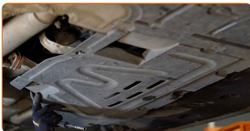
**24** Serrez les boulons de fixation du couvercle de protection. Utilisez une douille n° 8. Utilisez une clé à cliquet.
