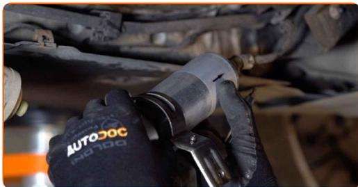
**19** Serrez la fixation du support du filtre à essence. Utilisez la mèche Torx T20. Utilisez une clé à cliquet.
