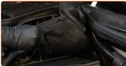
**6** Dévissez les attaches du cache moteur. Utilisez une douille n° 10. Utilisez une clé à cliquet.
