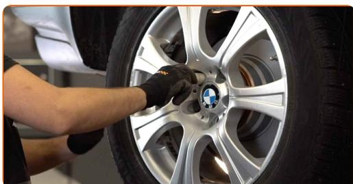
**28** Abaissez la voiture et serrez les boulons de roue en ordre croisé. Utilisez une clé dynamométrique. Serrez-le jusqu'à 140 Nm.
