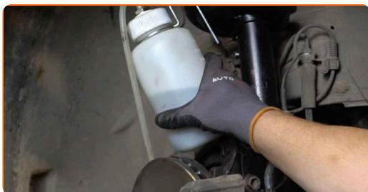
**32** Resserrez la vis de purge de l'étrier de frein. Utilisez une clé mixte de No.9 Utilisez une clé dynamométrique. Serrez-le jusqu'à 5 Nm.
