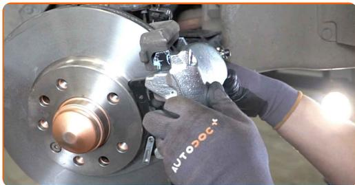
**19** Serrez les fixations de l'étrier de frein. Utilisez la clé HEX n° H7. Utilisez une clé dynamométrique. Serrez-le jusqu'à 28 Nm.
