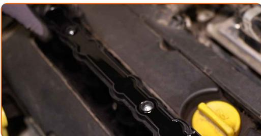
**10** Serrez les boulons des bobines d'allumage. Utilisez la mèche Torx T40. Utilisez une clé dynamométrique. Serrez-le jusqu'à 7 Nm.
