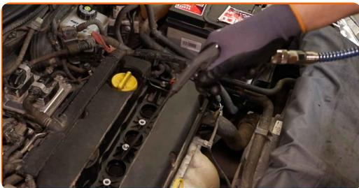
**9** Installez la nouvelle bobine d'allumage sur le puits de la bougie.
