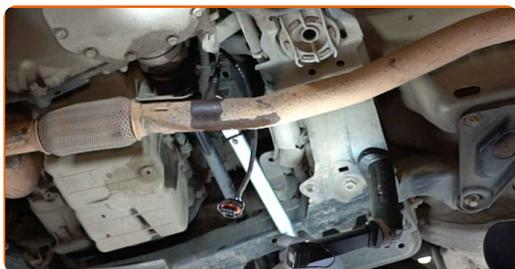
**12** Appliquez du produit sur le connecteur de la sonde lambda. Utilisez de la graisse diélectrique.
