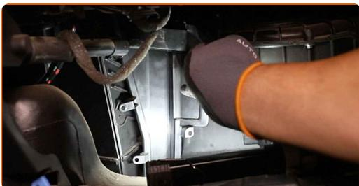
**14** Vissez les attaches du couvercle du boîtier du filtre d'habitacle. Utilisez une douille n° 5.5. Utilisez une clé à cliquet.
