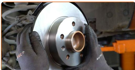
**21** Serrez l'attache du disque de frein. Utilisez la mèche Torx T30. Utilisez une clé dynamométrique. Serrez-le jusqu'à 4 Nm.
