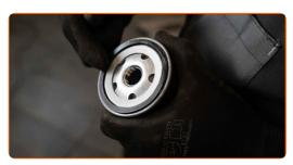
Vissez le filtre neuf en place. Utilisez la douille 76/14-F. Respecter bien le couple de serrage recommandé.
