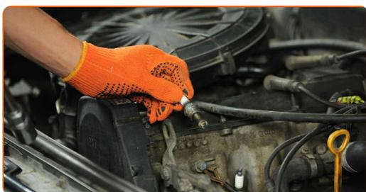
**7** Appliquez une fine couche d'antigrippant à haute température sur les fils des nouvelles bougies d'allumage.
