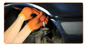
Serrez l'écrou de bloquage de l'extrémité de la barre. Utilisez une clé mixte de No.14 Utilisez une clé mixte de No.22 Utilisez une clé dynamométrique. Serrez-le jusqu'à 40 Nm.
