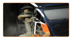
Appliquez du produit sur toutes les connexions de l'embout de biellette de direction. Utilisez de la graisse au cuivre.
