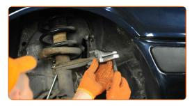
Déserrez l'écrou de bloquage qui retient l'extrémité de la barre stabilisatrice à la barre stabilisatrice. Utilisez une clé mixte de No.14 Utilisez une clé mixte de No.22
