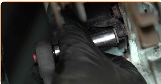
**19** Desserrez le collier de serrage du tuyau de refroidissement. Utilisez une douille n° 7. Utilisez une clé à cliquet.
