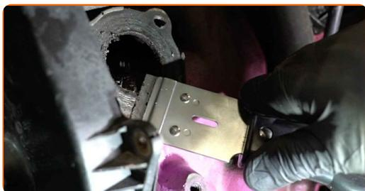
**24** Appliquez du produit sur l'emplacement de montage de la pompe à eau. Utilisez un enduit.
