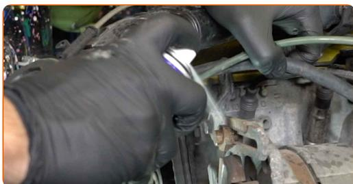
**14** Desserrez les fixations de l'alternateur. Utilisez une clé mixte de No.13.
