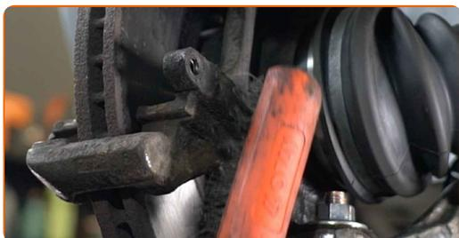
**13** Dévissez l'attache du support d'étrier. Utilisez une douille n° 17. Utilisez un porte-taraud.
