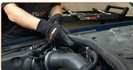
**4** Dévissez les fixations du cache d'auvent. Utilisez la mèche Torx T20. Utilisez un tournevis plat.
