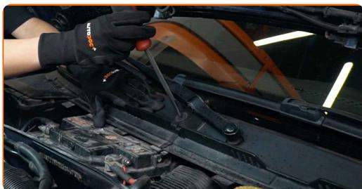
**14** Installez la grille d'auvent et fixez-la. Utilisez la mèche Torx T20. Utilisez un tournevis plat.
