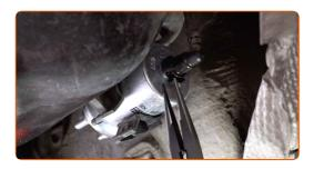
Serrez les attaches du filtre à carburant. Servez-vous d'un tournevis Phillips.
