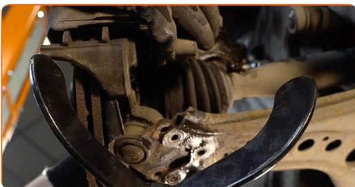
**21** Dévissez les fixations qui lient l'arbre de transmission au moyeu de roue. Servez-vous d'une douille 12 pans N°36.
