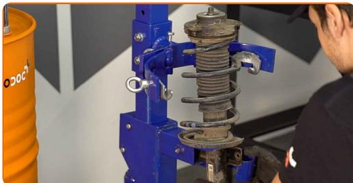
Remplacement : coupelle d'amortisseur – AUDI A2 (8Z0). Les professionnels recommandent :
