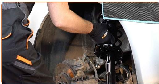
**38** Vissez l'attache supérieure du support de l'amortisseur. Ne serrez pas trop.
