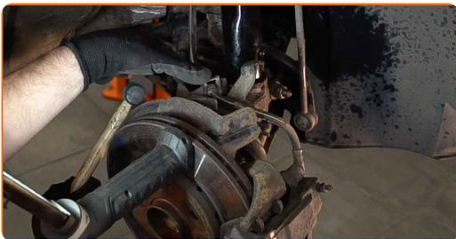
**52** Nettoyez le siège de fixation de la jante. Utilisez une brosse métallique. Traitez la surface de contact. Utilisez de la graisse au cuivre.
