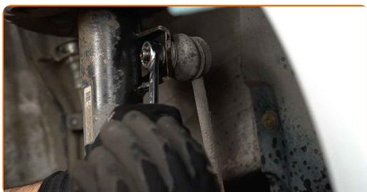
**13** Dévissez la fixation inférieure assurant la connexion entre la jambe d'amortisseur et le porte-fusée. Utilisez une clé mixte de No.18. Utilisez une douille n° 18. Utilisez un porte-taraud.
