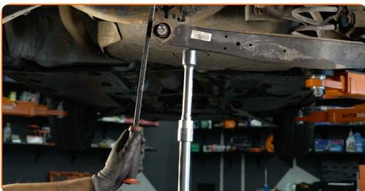
Remplacement : bras de commande inférieur de suspension arrière – AUDI A3
