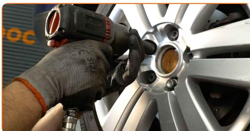
**35** Abaissez la voiture et serrez les boulons de roue en ordre croisé. Servez-vous d'une douille à choc pour roue N°17. Utilisez une clé dynamométrique. Serrez-le jusqu'à 120 Nm.
