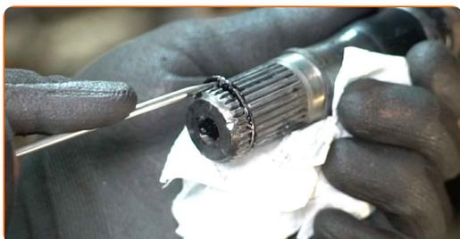
**27** Nettoyez les cannelures de joint de l'arbre de transmission. Utilisez une brosse métallique. Servez-vous d'un aérosol nettoyant multi-usages.
