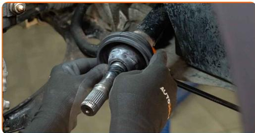
**29** Installez le circlip du joint homocinétique.
