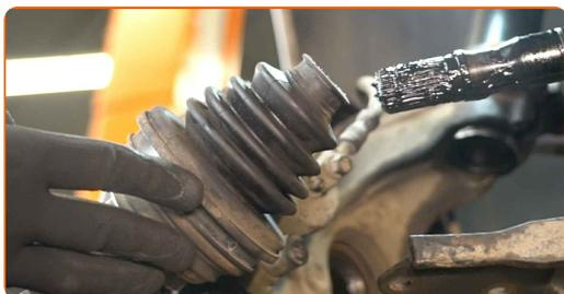
**25** Détachez le siège de montage du joint homocinétique. Servez-vous d'un aérosol nettoyant multi-usages.
