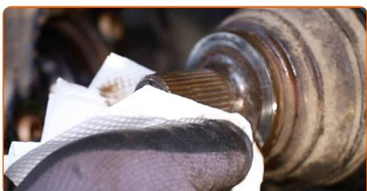
**33** Appliquez du produit sur les cannelures de joint de l'arbre de transmission. Utilisez de la graisse au cuivre.
