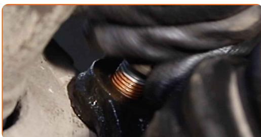
**46** Serrez les fixations du support d'étrier de frein. Utilisez une douille n° 21. Utilisez une clé dynamométrique. Serrez-le jusqu'à 190 Nm.
