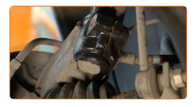
Dévissez les fixations qui lient l'arbre de transmission au moyeu de roue. Utilisez une douille n° 24. Utilisez une clé à cliquet.
