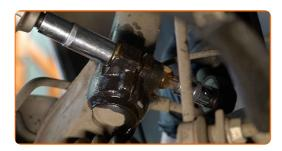
18 Retirez l'écrou de fixation.
