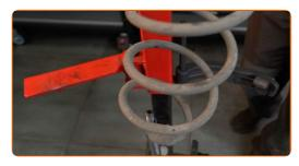
Retirez l'amortisseur usagé du compresseur à ressort hydraulique hélicoïdal.
