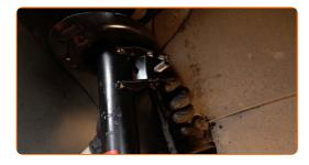
Resserez la fixation de la biellette de la barre stabilisatrice. Utilisez une douille n° 18. Utilisez une clé à cliquet.
