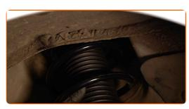
Vissez l'attache supérieure du support de l'amortisseur. Ne serrez pas trop.
