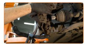
Relâchez la fixation inférieure assurant la connexion entre la jambe d'amortisseur et le porte-fusée. Servez-vous d'une douille spéciale pour retirer l'amortisseur. Utilisez une clé à cliquet.
