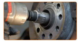
Retirez l'écrou de fixation.
