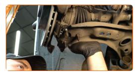
Vissez les fixations de la rotule. Utilisez une douille n° 16. Utilisez une clé à cliquet.
