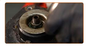
Retirez l'écrou de la tige de piston de l'entretoise. Utilisez la clé HEX n° H7. Utilisez une douille n° 21. Utilisez une clé à cliquet.
