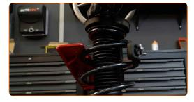
Serrez l'écrou de l'entretoise d'amortisseur due la tige de piston. Utilisez la clé HEX n° H6. Utilisez une douille n° 21. Utilisez une clé dynamométrique. Serrez-le jusqu'à 60 Nm.
