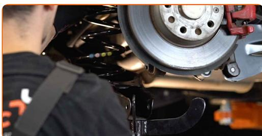
**26** Serrez les fixations reliant le bras de suspension à la fusée arrière. Utilisez une clé mixte de No.18. Utilisez une douille n° 18. Utilisez une clé dynamométrique. Serrez-le jusqu'à 90 Nm.+90°
