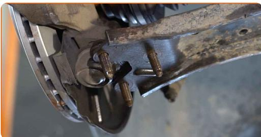
**57** Vissez la fixation reliant le joint à rotule au bras de commande. Utilisez une douille n° 16. Utilisez une clé à cliquet.
