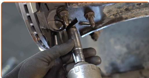
**58** Installez le boulon de l'arbre de transmission et serrez-le. Utilisez une douille n° 27. Utilisez une clé à cliquet.
