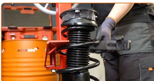
**44** Lubrifiez la barre d'amortisseur. Utilisez de la graisse au cuivre.
