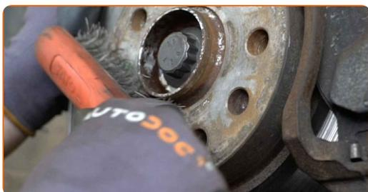
**68** Appliquez du produit sur la zone de contact entre le disque de frein et la jante. Utilisez du lubrifiant céramique.
