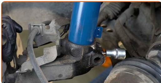
50 Installez l'écrou de fixation.
