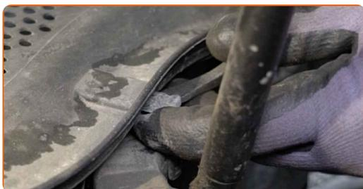
**5** Poussez la grille d'auvent sur le côté pour accéder aux fixations du support de jambe de suspension.
