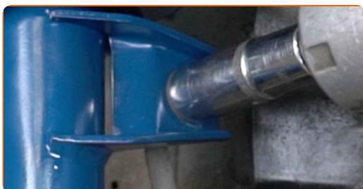
**60** Surélevez la fusée d'essieu. Serrez vous d'un cric à transmission hydraulique.
