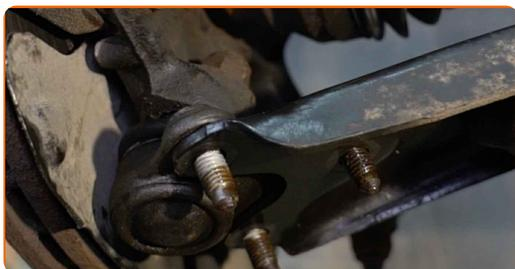
**54** Serrez les fixations qui relient le joint à rotule au bras de suspension. Utilisez une douille n° 16. Utilisez une clé à cliquet.
