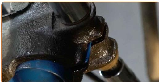
**56** Installez le boulon de l'arbre de transmission et serrez-le. Servez-vous d'une douille 12 pans n°24. Utilisez une clé à cliquet.
