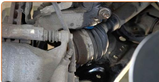
**53** Attachez le joint à rotule au bras de contrôle.
