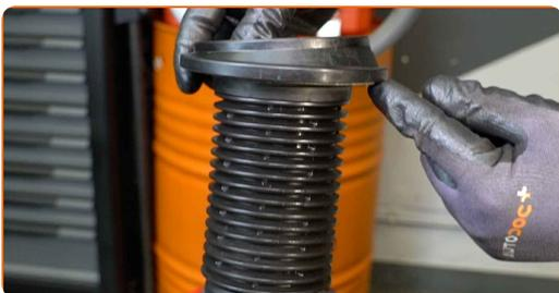
**41** Installez la jambe de suspension supérieure en même temps que la butée.
