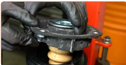
**42** Serrez l'écrou de l'entretoise d'amortisseur due la tige de piston. Utilisez une douille pour ecrou de jambe de suspension de 21 mm. Utilisez la clé HEX n° H7. Utilisez une clé dynamométrique. Serrez-le jusqu'à 60 Nm.
