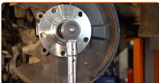
Remplacement : roulement de roue – AUDI A4 Avant (8ED, B7). Conseil des experts d'AUTODOC :
