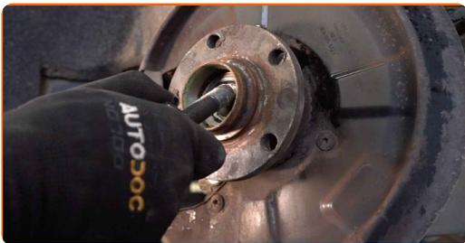
**19** Retirez le moyeu et le roulement puisqu'ils forment un bloc hermétique.
