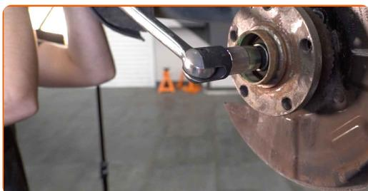
**18** Retirez l'écrou de fixation.
