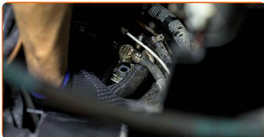
Remplacement : filtre à carburant – AUDI A4 Avant (8K5, B8). Les professionnels recommandent :
