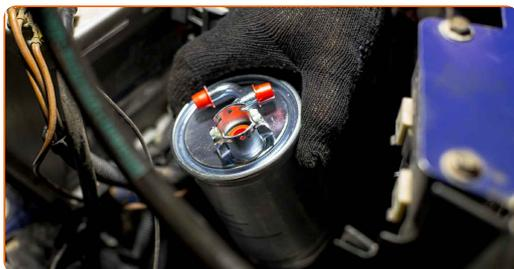
Remplacement : filtre à carburant – AUDI A4 Avant (8K5, B8). Les experts d'AUTODOC recommandent :
