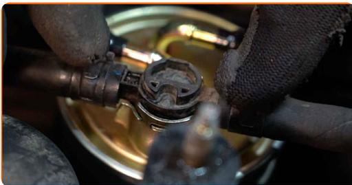
18 Installez la pièce de retenue du tuyau du filtre à carburant.
