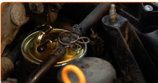
19 Attachez les tuyaux au filtre à carburant.
