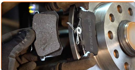
**26** Installez l'étrier de frein et fixez-le. Utilisez une douille n° 13. Utilisez une clé mixte de No.15 Utilisez une clé dynamométrique. Serrez-le jusqu'à 35 Nm.
