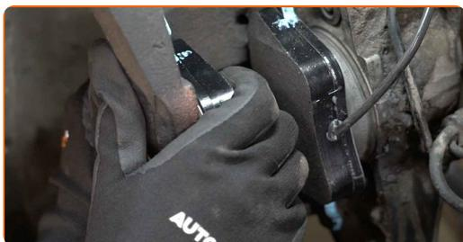
**30** Installez l'étrier de frein et fixez-le. Utilisez la clé HEX n° H7. Utilisez une clé dynamométrique. Serrez-le jusqu'à 30 Nm.
