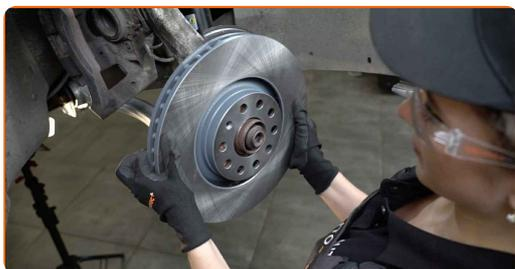
**23** Serrez l'attache du disque de frein. Utilisez la mèche Torx T30. Utilisez une clé dynamométrique. Serrez-le jusqu'à 5 Nm.
