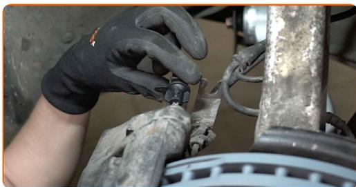
**34** Connectez le connecteur du capteur d'usure de la plaquette de frein.
