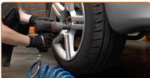
**39** Abaissez la voiture et serrez les boulons de roue en ordre croisé. Servez-vous d'une douille à choc pour roue N°17. Utilisez une clé dynamométrique. Serrez-le jusqu'à 120 Nm.
