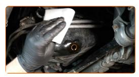
Vissez le nouveau bouchon de vidange et le resserrez. Utilisez la mèche Torx T45. Utilisez une clé dynamométrique. Serrez-le jusqu'à 26 Nm.
