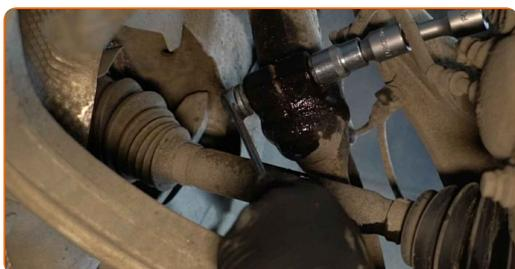
**21** Retirez l'écrou de fixation.
