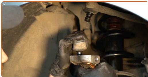
**79** Installez l'écrou de fixation.
