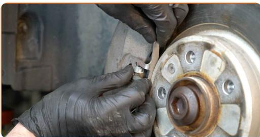
**87** Installez l'écrou de fixation.
