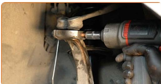
**81** Vissez l'écrou de fixation reliant l'embout de biellette à la fusée d'essieu. Utilisez une clé mixte de No.21
