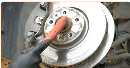
**23** Dévissez l'écrou de l'axe de moyeu de roue. Utilisez la clé HEX n° H18. Utilisez un porte-taraud.
