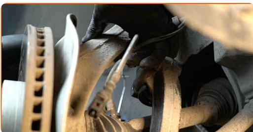
**85** Installez l'étrier de frein et fixez-le. Utilisez une douille n° 13. Utilisez une clé dynamométrique. Serrez-le jusqu'à 30 Nm.
