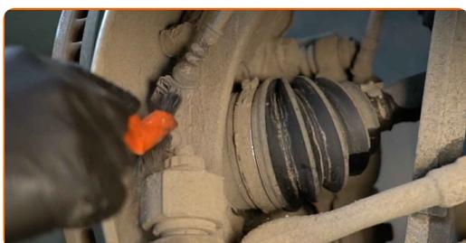
**27** Détachez le connecteur du capteur ABS.
