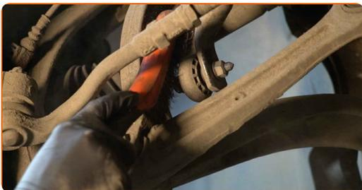
**20** Dévissez le boulon de fixation reliant la jambe d'amortisseur à la fourchette d'amortisseur. Utilisez une clé mixte de No.18 Utilisez une douille n° 18. Utilisez une clé à cliquet.
