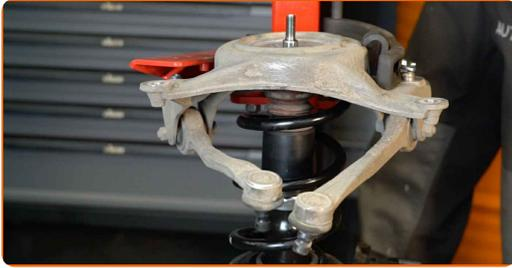
**60** Serrez l'écrou de l'entretoise d'amortisseur due la tige de piston. Utilisez une douille n° 18. Utilisez la clé HEX n° H6. Utilisez une clé dynamométrique. Serrez-le jusqu'à 50 Nm.
