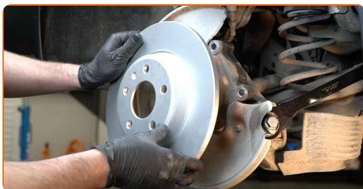
**21** Serrez l'attache du disque de frein. Utilisez la mèche Torx T30. Utilisez une clé dynamométrique. Serrez-le jusqu'à 5 Nm.
