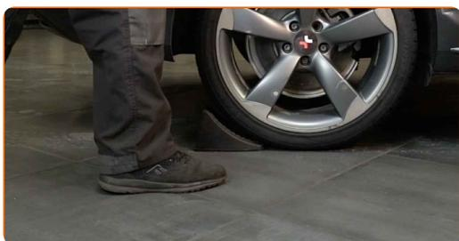
4 Desserrez les boulons de fixation de la roue. Servez-vous d'une douille à choc pour roue N°17.
