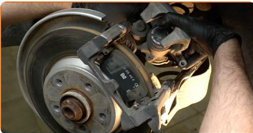
Remplacement : disques de frein – AUDI A4 B9 Avant (8W5, 8WD). Les experts d'AUTODOC recommandent :
