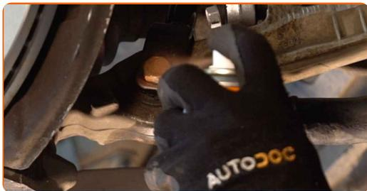
**45** Appliquez du produit sur la zone de contact entre le disque de frein et la jante. Utilisez de la graisse au cuivre.
