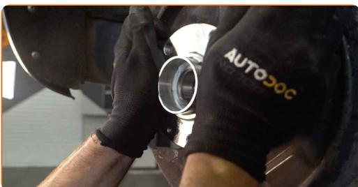
**22** Installez l'écrou de fixation.
