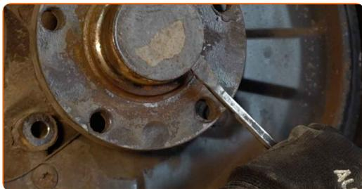
Remplacement : roulement de roue – AUDI A4 Berline (8E2, B6). Conseil d'AUTODOC :
