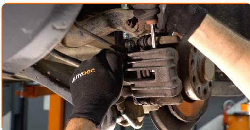
Remplacement : roulement de roue – AUDI A4 Berline (8E2, B6). Les experts d'AUTODOC recommandent :
