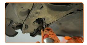
Serrez la fixation reliant la biellette à la barre stabilisatrice. Utilisez une clé mixte de No.16 Utilisez une clé mixte de No.18 Utilisez une clé dynamométrique. Serrez-le jusqu'à 45 Nm.
