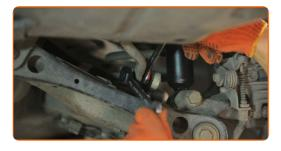
Retirez l'écrou de fixation.
