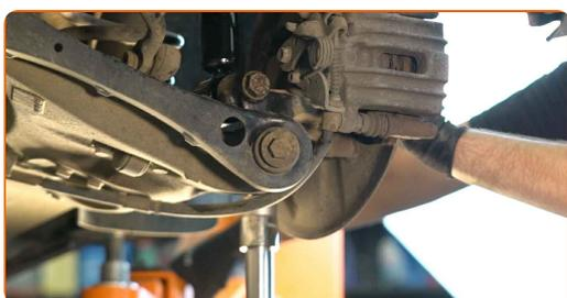
**30** Serrez l'attache inférieure de l'amortisseur. Utilisez une clé mixte de No.21 Utilisez une douille n° 21. Utilisez une clé dynamométrique. Serrez-le jusqu'à 150 Nm.+90°
