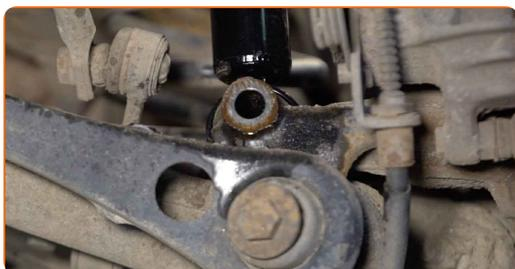
**27** Installez l'écrou de fixation.
