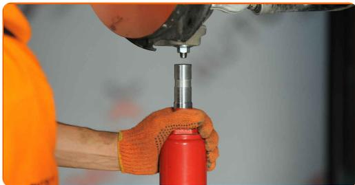
**45** Serrez l'attache inférieure de l'amortisseur. Utilisez une clé mixte de No.18. Utilisez une douille n° 18. Utilisez une clé dynamométrique. Serrez-le jusqu'à 90 Nm.
