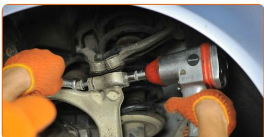
**43** Installez l'écrou de fixation.
