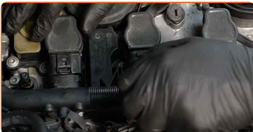
**15** Vissez les fixations du guidage de cables de la bobine d'allumage. Utilisez la mèche Torx T30. Utilisez une clé à cliquet.
