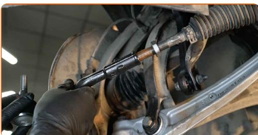
Remplacement : rotule de direction – AUDI A5 Coupe (8T3). Les experts d'AUTODOC recommandent :
