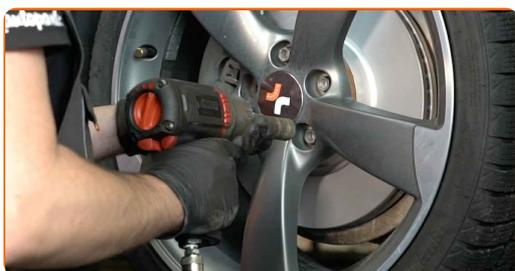
**25** Abaissez la voiture et serrez les boulons de roue en ordre croisé. Servez-vous d'une douille à choc pour roue N°17. Utilisez une clé dynamométrique. Serrez-le jusqu'à 120 Nm.
