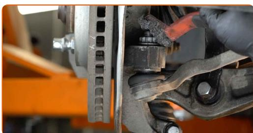
**7** Dévissez l'écrou d'attache d'extrémité à la fusée d'essieu. Utilisez une clé mixte de No.21
